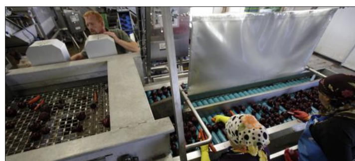
Semi-automatique, la lessiveuse nécessite encore beaucoup de travail manuel.
